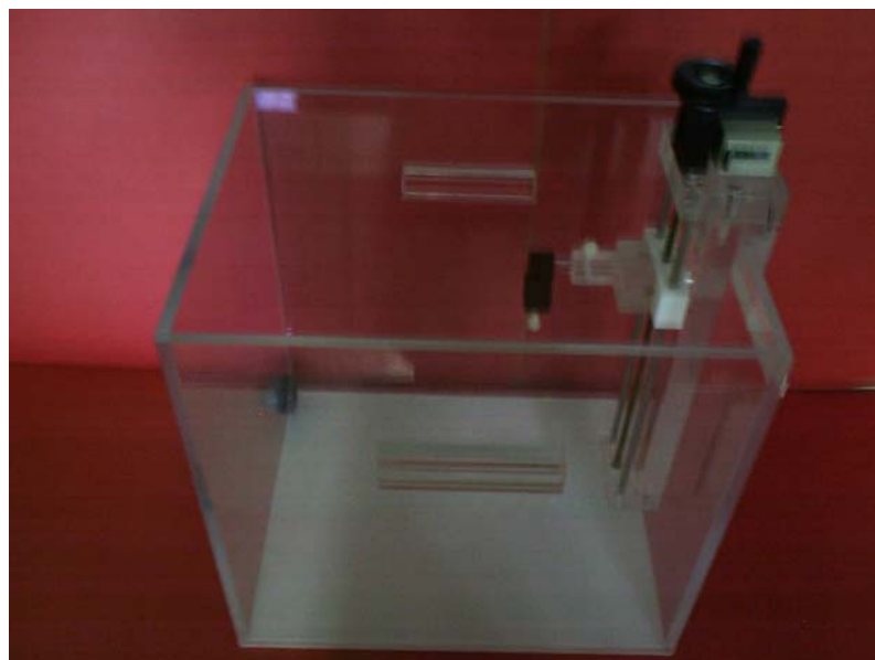
FIGURA 4 – Fantoma e suporte com posicionador manual para câmara de ionização.
