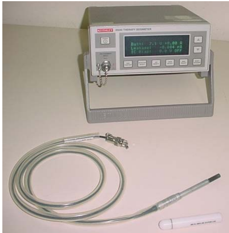
FIGURA 3 – Conjunto dosimétrico: câmara de ionização e eletrômetro.
