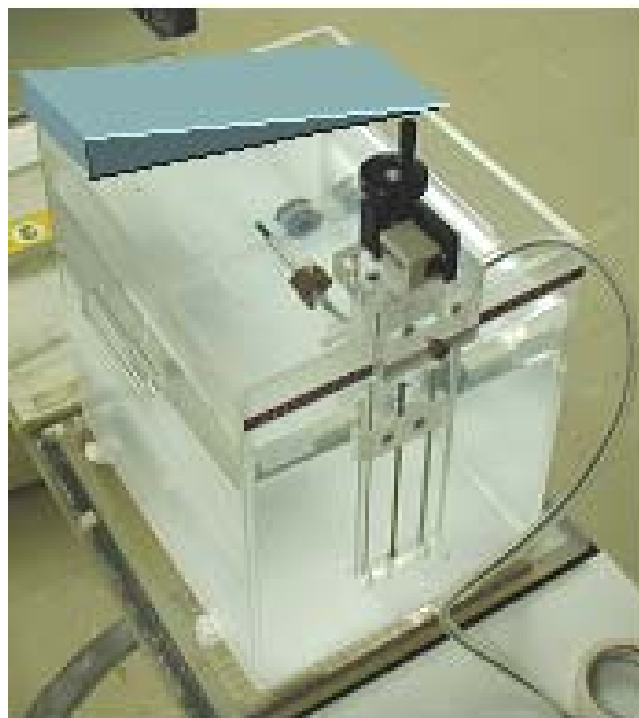
FIGURA 5 – Demonstração do posicionamento da câmara de ionização em relação ao filtro.
