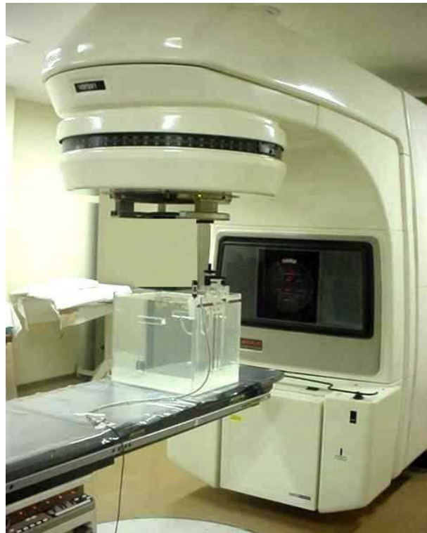
FIGURA 2 – Montagem experimental: acelerador linear, fantoma e câmara de ionização.
