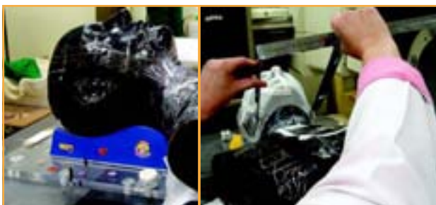
Figura 6.23 - Simulador antropomórfico posicionado en el soporte de cabeza y cuello (izq.); y medición de la DLL en la región inmovilizada (der.)
