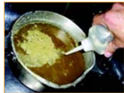
Figura 4.13 - Tornando la cera pastosa con un chorro de agua fría
