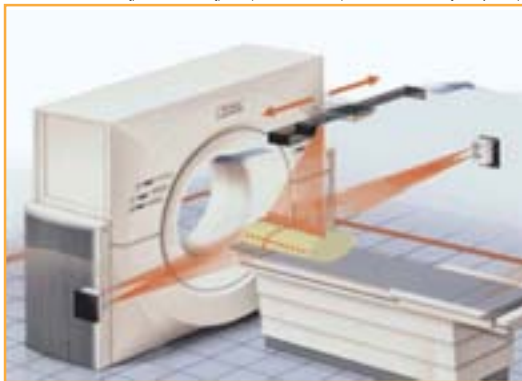
Figura 2.24 - Esquema de una sala con un CT-simulador
