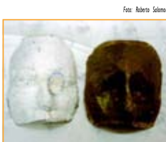
Foto: Roberto Solomon Figura 4.5 - Molde negativo en yeso para la confección de máscaras (molde positivo).
