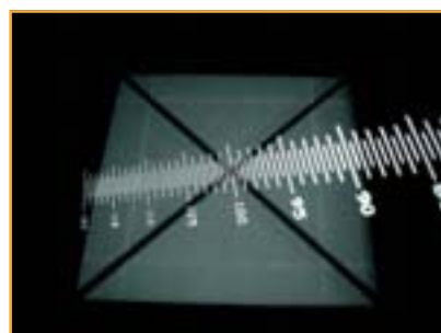
Figura 5.10 - Ejemplo de un telémetro en un equipo de Co-60 con DFI igual a 100 cm
