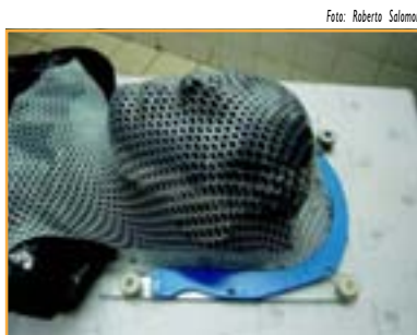
Figura 4.24 - Material termoplástico colocado en el simulador antropomórfico
