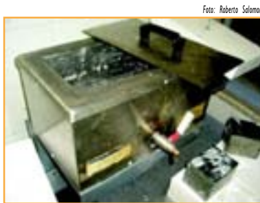
Figura 4.46 - Cerrobend ® calentado en el horno
