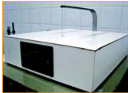
Figura 4.10 - Cortador de poliestireno del tipo simple, usado para confeccionar protecciones para haces de electrones.
