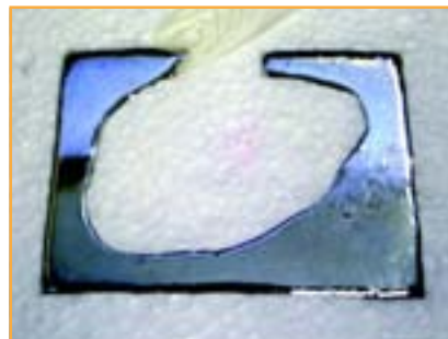
Figura 4.8 - Forma de poliespuma rellena con cerrobend ® derretido
