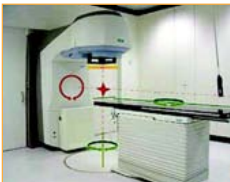
Figura 2.21 - Algunos grados de libertad en los movimientos del acelerador lineal: rotación del gantry (flecha roja), rotación de la mesa (flechas verdes). La "estrella" roja define el isocentro, que está localizado en la intersección entre las líneas de punto
