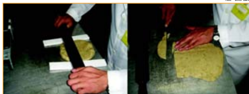
Figura 4.15 - Confección del bolus de cera con espesura definida (izq.); y remate de los bordes del bolus (der.)
