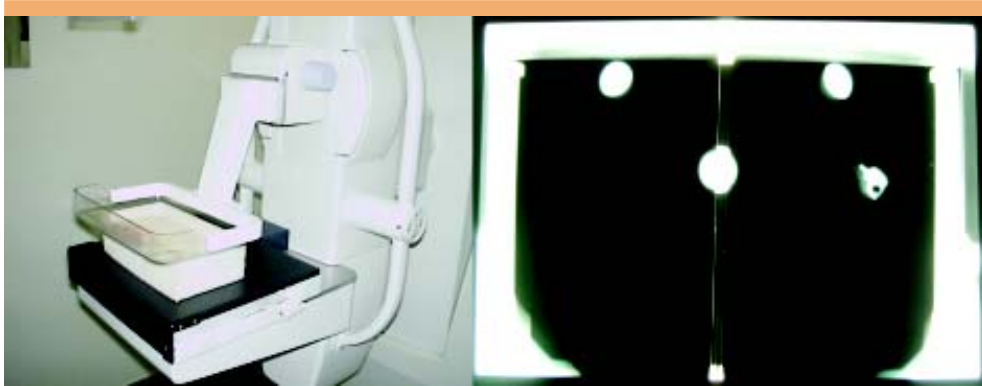
Figura 23 - Arranjo e resultado do teste de alinhamento entre o campo de raios X e o filme radiográfico
