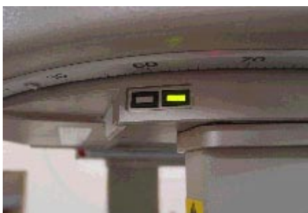
Fig. 4 – "Led" de segurança da fixação da bandeja
