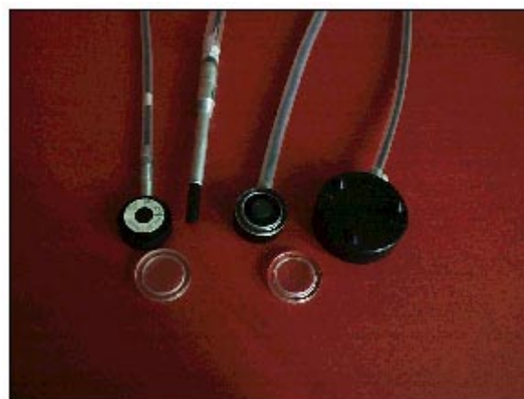
Fig. 2 – Fantoma semi-infinito e detectores de radiação
