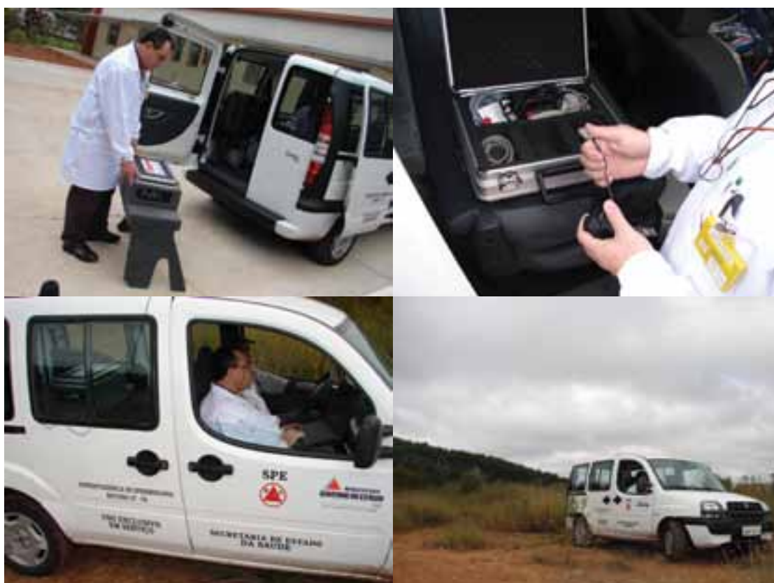
FIGURA 5 – Conjunto instalado em um veículo de passeio: detector gama de alta sensibilidade acoplado a um GPS e a um microcomputador.
