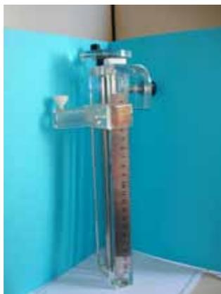
**Figura 14** – Protótipo PQRT e o suporte para Sistema Postal para CQ em feixes de elétrons
