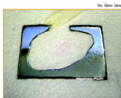
Figura 4.8 - Molde de bloco em isopor preenchido com *cerrobend®* derretido
