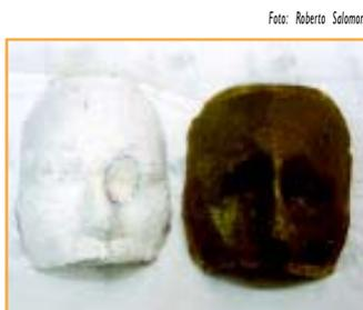
Figura 4.5 - Molde negativo em gesso para a confecção de máscaras (molde positivo)
