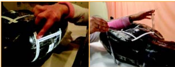
Figura 6.18 - Marcações do centro do campo e dos limites do campo lateral (esq.); e medida da DLL no centro do campo lateral (dir.)
