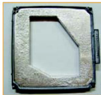
**Figura 3.19** - Bloco de proteção para tratamento com feixe de elétrons
