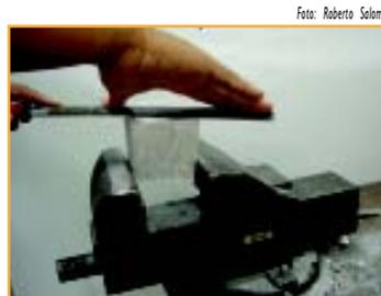
Figura 4.49 - Arremate do bloco de *cerrobend*®
