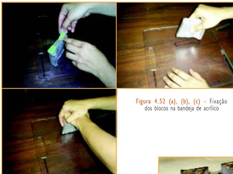
Figura 4.52 (a), (b), (c) - Fixação dos blocos na bandeja de acrílico
