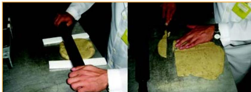
Figura 4.15 - Confecção do bólus de cera com espessura definida (esq.); e arremate das bordas do bólus (dir.)
