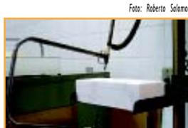
**Figura 4.40** - Detalhe do fio metálico do cortador de isopor
