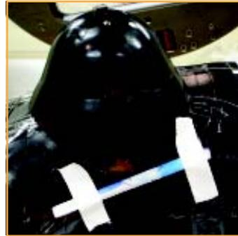
Figura 6.43 - Detalhe do fio metálico usado como referência, para definição do limite inferior do campo de irradiação
