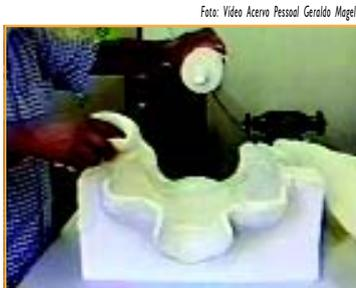
Figura 4.33 - Aplicação de cola para fixação da espuma no berço
