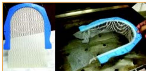
Figura 4.23 - Material termoplástico virgem (esq.); e sendo aquecido para confecção da máscara (dir.)
