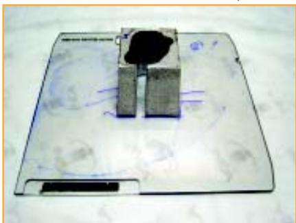
Figura 3.17 - Bandeja de acrílico com blocos de **cerrobend®**
