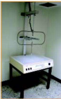
Figura 4.9 - Cortador de isopor para blocos a serem usados em feixes de fótons
