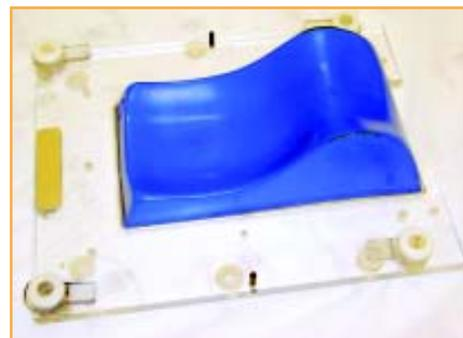
Figura 3.3 - Base com suporte de cabeça para fixação da máscara termoplástica
