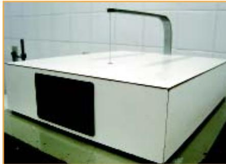
Figura 4.10 - Cortador de isopor do tipo simples, usado para confecção de proteções para feixes de elétrons
