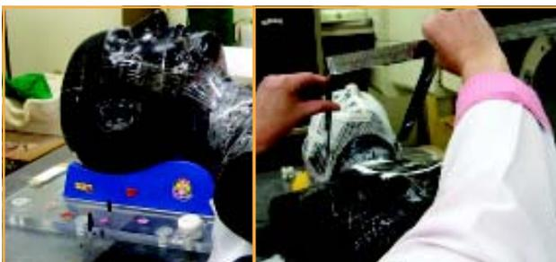
Figura 6.23 - Fantoma antropomórfico posicionado no suporte de cabeça e pescoço (esq.); e medição da DLL da região imobilizada (dir.)
