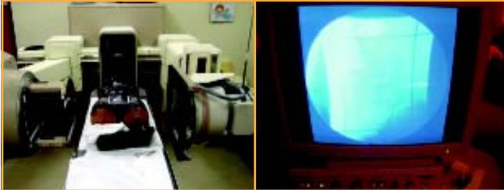
Figura 6.16 - Fantoma posicionado no simulador convencional para definição dos campos laterais (esq.); e fluoroscopia para definição dos limites e do centro do campo lateral de irradiação (dir.)
