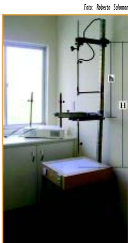
**Figura 4.38** - Cortador de isopor para blocos a serem usados em feixes de fótons
