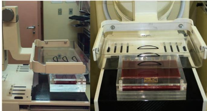
Figura 109. Montaje experimental para la verificación del CAE
