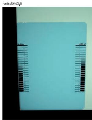
Figura 101. Película de prueba sensitométrica observada en un negatoscopio
