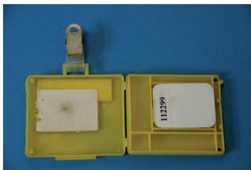
Figura 120. Interior de un dosímetro individual
