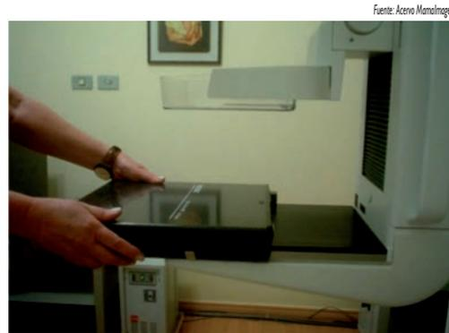
Figura 49. Normalmente no se observa la célula fotoeléctrica, pues la misma se encuentra debajo del porta chasis. En la foto, el técnico retira el porta chasis, permitiendo la identificación de la misma
