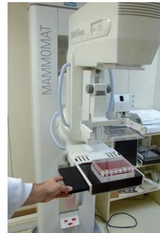
Figura 107. Posicionamiento de placas de acrílico para pruebas
