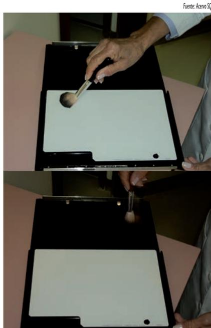
Figura 46. Técnica limpiando el chasis y la pantalla intensificadora
