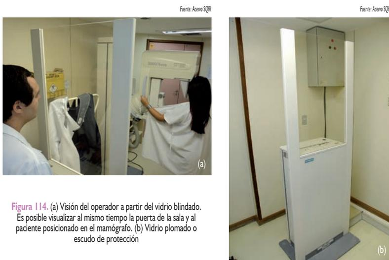
Figura 114. (a) Visión del operador a partir del vidrio blindado. Es posible visualizar al mismo tiempo la puerta de la sala y al paciente posicionado en el mamógrafo. (b) Vidrio plomado o escudo de protección
