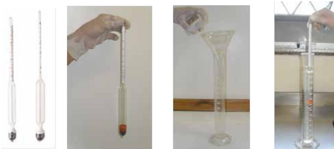
**Figura 1** - Verificação da concentração de álcool com alcoômetro
